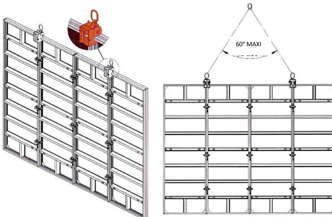
Dans le cas des banches de Ht 150 cm, 135 cm, 120 cm et 90 cm, procéder au montage de la même manière que les banches de Ht 270 cm.
