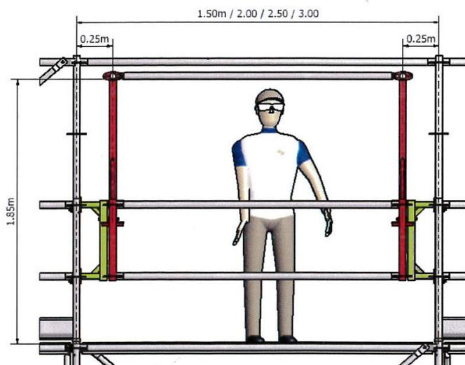
Le garde-corps est dimensionné pour basculer entre 2 niveaux de plancher de 2m.
